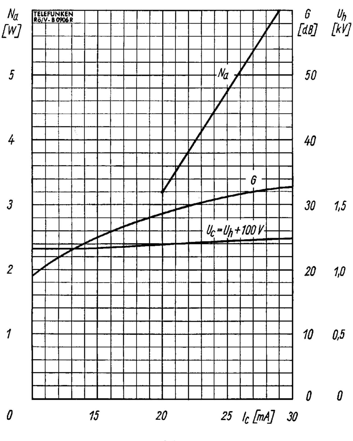
$$\begin{split} N_{\sigma},G,U_{h} &= f\left(I_{c}\right)\\ N_{e} &= 5 \text{ mW}\\ f &= 4 \text{ GHz} \end{split}$$
